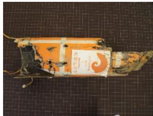
図10 破損したロケット上部
